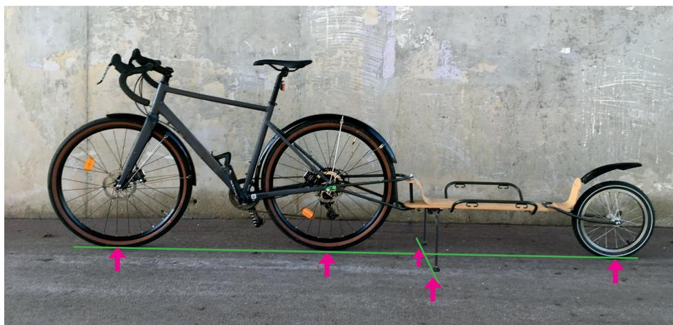
5 Réglage de la hauteur de la béquille : Sur un sol plat, à vide, en position ouverte.
