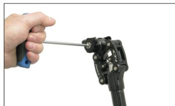
Installez la selle en insérant la glissière dans la fixation par un côté.
