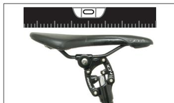
Serrez les deux boulons de fixation à un couple de serrage de 15-18 Nm avec une clé Allen de 5 mm.
