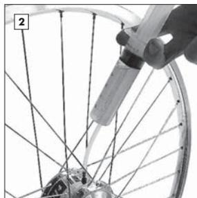
Remplissez la seringue avec les 25 ml d'huile de rinçage puis vissez le tuyau d'injection dans le filetage de la vis de vidange. Une fois injecté l'huile dans le moyeu, aspirez avec la seringue 25 ml d'air pour équilibrer la pression, dévissez le tuyau et réinsérez l'ancienne vis de vidange.
