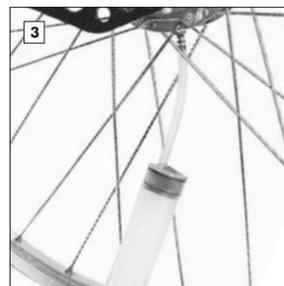
Retirez le mélange huile/rinçage en réinsérant la seringue dans le moyeu et tournez l'orifice de vidange vers le bas. Laissez égoutter l'ensemble env. 15 mn et retirez les gouttes restantes. Injectez l'huile usagée dans la bouteille de 50 ml.
